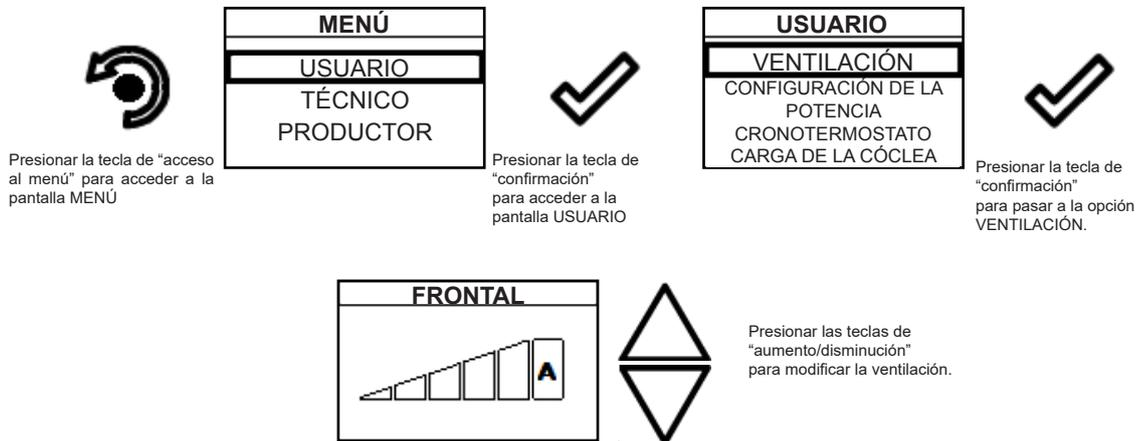
Gestión: la velocidad de ventilación o de los conductos se puede poner a 0 (desactivada) el ajuste de 1 a 5 permite la elección de la velocidad de propagación del calor. Si el valor se ajusta en AUTO, la ventilación sigue la potencia ajustada de la estufa.
