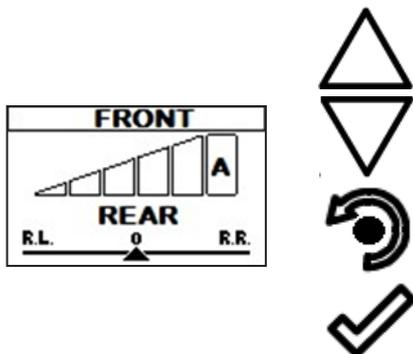
Use las teclas “ARRIBA” y “ABAJO” para modificar la potencia de la ventilación frontal (el dato se guarda sin tener que confirmar). El valor que se puede configurar va de 0 (ventilación frontal apagada) a 5. Con la configuración en A (automática), la potencia de la ventilación se corresponde con la potencia de la estufa (en algunos modelos este ajuste puede limitarse o desactivarse).
